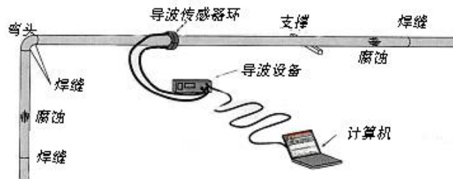
图 6 超声导波检测原理图
