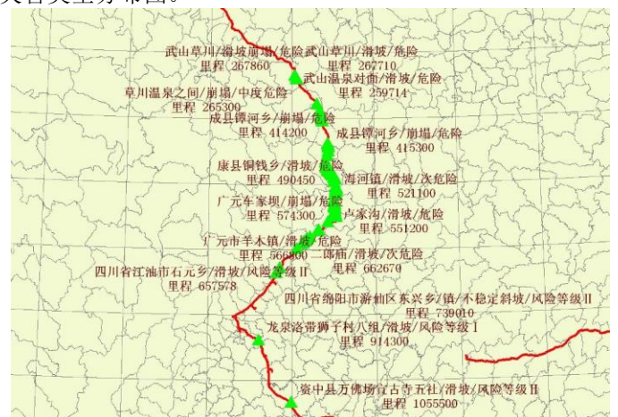
图7 兰成渝管道震区已有的地质灾害类型分布图
